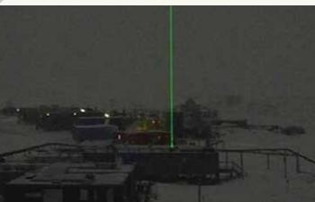
基地から南極の夜空へと真っ直ぐ伸びる不思議な光、「マイクロパルスライダー」と呼ばれるこの光は、雲の高さを測定するためのものだそうです。この光、普段は夜の暗闇でも目視することができず、雪が降ると写真のように雪粒に当たった光が見えるとか。高度60kmまでの雲の高さが測定でき、データは気候の予測変化に用いられています。
