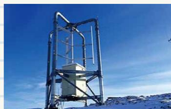
昭和基地では自然エネルギーも利用されていますが、高木隊員が着目したのは風力発電の独特な形状です。一般的な風力発電はプロペラの形をしているが、昭和基地の風力発電は円柱型。40m/sの風速で吹くブリザードに備え、強風でも破損しないよう工夫がされているのです。
