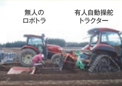
自動操舵付きトラクターとロボトラ。ロボトラには小塙鉄工所特注品のコンテナ、トレーラーを装着。
