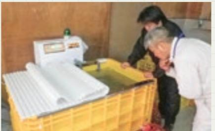
低コストで農薬を使わない温湯処理機「湯芽工房」は、試験場の研究者とのコラボによって誕生した。
