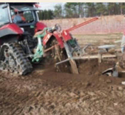
自動操舵付きトラクターの後部には、地元メーカー・苦米地技研工業の掘取り機を装着。
