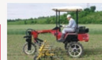
●作業機を本機中央に配置するミッドマウント方式のため、振り返って作業状態を確認する必要がなく、疲労を軽減します。
