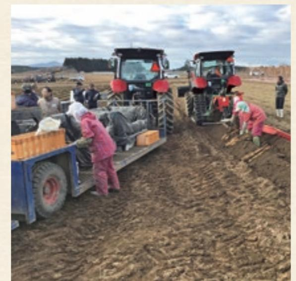
右側の掘取り作業が先に進み(有人の自動操舵トラクター)、続いて左側の運搬作業が追従する(無人のロボトラ®)
