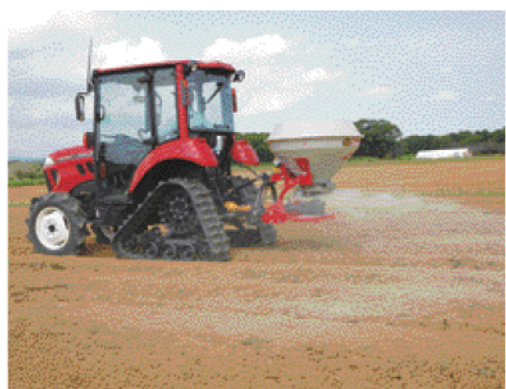
作業機の下が小さく撒きムラの少ない均一な散布が可能
