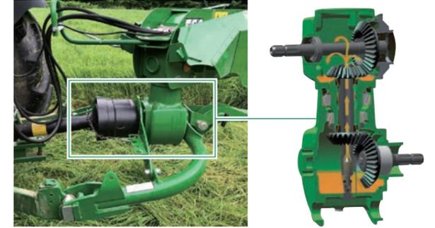
PTOシャフトジョイントは常に真っ直ぐな状態を保つため、ノイズの発生や摩擦が減り、効率的な動力伝達を実現します。また、オイル交換が容易でメンテナンス時間の短縮も可能です。
