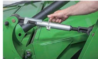
工具を使わずに、地面に対するカッティングユニットの角度を35～65mmの間で簡単に調整できます。
