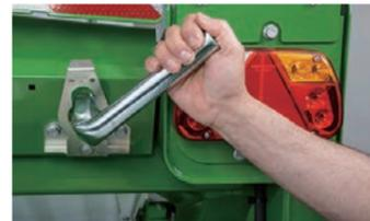
カッティングユニットの接地圧を左右独立で調整可能。ほ場への追従性を高め、均一な刈取りを実現します。
