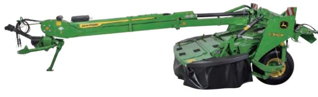
左右どちらにもオフセットできるため、広大なほ場での往復作業ができます。また、アシンメトリックスワスボードにより、フロントモアコンとの組み合わせや往復作業で効率良くピックアップ作業が行えます。
