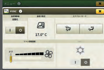
オートエアコン キャビン内を快適な温度・湿度に維持します。コマンドセンターで調整。
