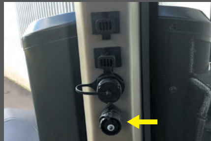
信号取出し (7極) 車速 (対地速度、ホイール速度) の信号を取出しできます。ISO11786に準拠
