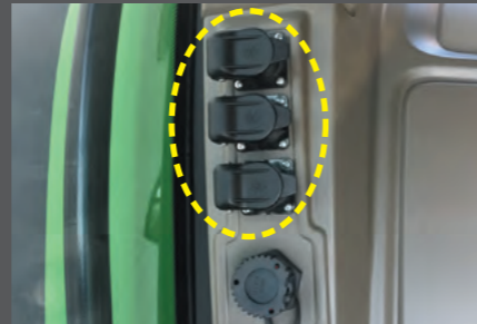
電源取出し (6つ) 6つの電源取出しを装備。12Vの電源取出しに対応。
