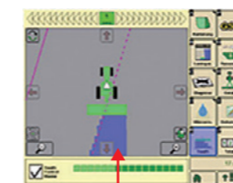
散布作業中のモニター画面表示 散布している箇所としていない箇所がしっかりと分けられます。
