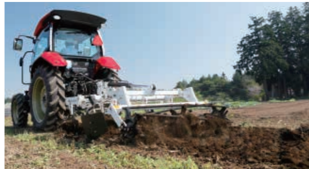
粗耕起作業:スタブルカルチ(スガノ農機)
