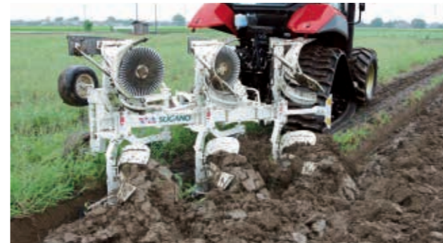
反転耕作業:プラウ(スガノ農機)
