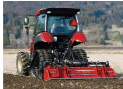
ナロークローラ仕様 クローラ幅280mmのナロークローラ仕様は、畑作管理作業に最適です。
