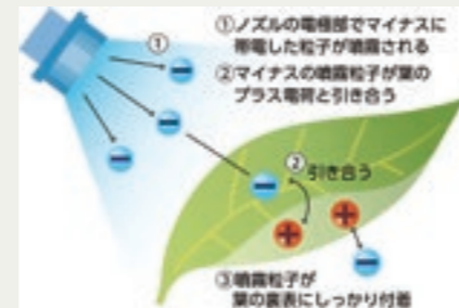
静電ノズルの動作原理。噴霧する農薬にノズルの電極でマイナスの電荷を与える。
