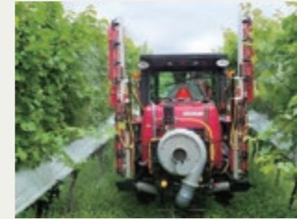
ワイナリー向け静電ブームWS300を搭載したヤンマートラクター。キャビンの中でムダ・ムラの無い散布が可能だ。
