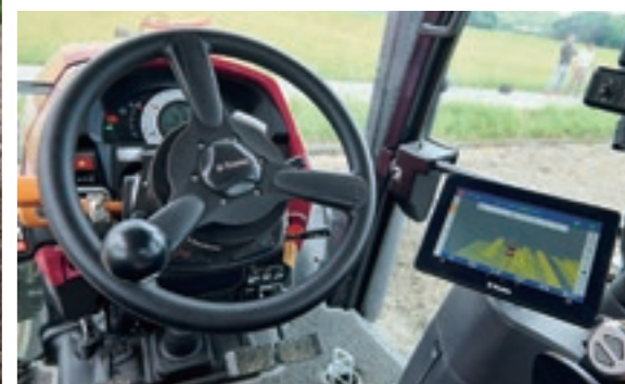
RTKアップグレードをした自動操舵システムは±2~3cmの高精度な作業ができ、スムーズでまっすぐなうね立てを行える。ハンドルは自動操舵システムが精密に制御するため、田中氏は後方のうねの確認に集中されていた。3m幅のロータリーと、1.5m×2連仕様のうね立て機によって作業の効率が飛躍的に向上したという。
