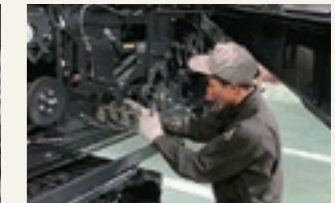
コンベアを抜き出し、変形やベアリングに破損がないか点検する。
