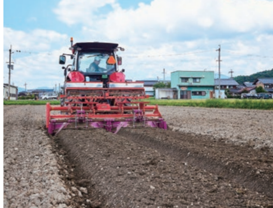
RTKアップグレードをした自動操舵システムは±2~3cmの高精度な作業ができ、スムーズでまっすぐなうね立てを行える。ハンドルは自動操舵システムが精密に制御するため、田中氏は後方のうねの確認に集中されていた。3m幅のロータリーと、1.5m×2連仕様のうね立て機によって作業の効率が飛躍的に向上したという。
