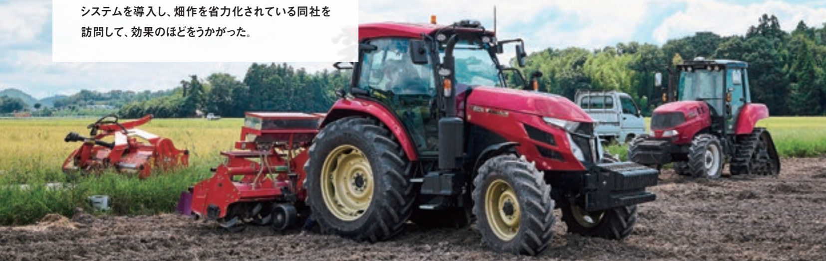
RTKアップグレードをした自動操舵システムは±2~3cmの高精度な作業ができ、スムーズでまっすぐなうね立てを行える。ハンドルは自動操舵システムが精密に制御するため、田中氏は後方のうねの確認に集中されていた。3m幅のロータリーと、1.5m×2連仕様のうね立て機によって作業の効率が飛躍的に向上したという。
