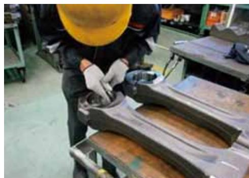
ロッドの面取り方法および工具の変更により作業時間を短縮
