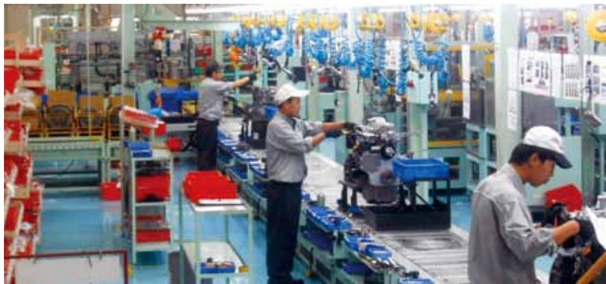
新設した立形水冷ディーゼルエンジンの生産ライン
