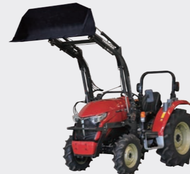
YTトラクターとのベストマッチポイント 高精度な平行昇降とスムーズな前後進で、オペレータの負担を軽減!
