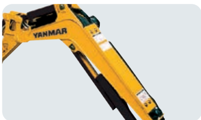
ブーム背面ホースとブームシリンダーに保護カバーを採用
