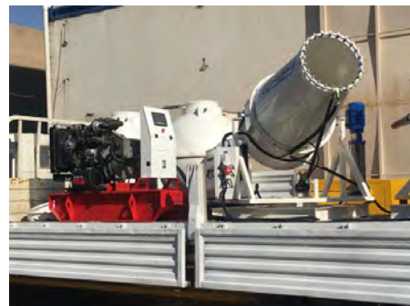
トラックに積載した発電機と噴霧装置で消毒作業を実施
