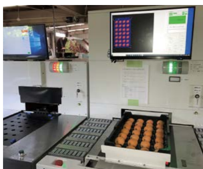
びわの外観・重量・内部品質計測システム
