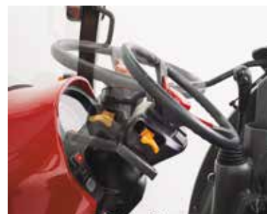
Stuurwiel verstelbaar voor afstemming op de operator
