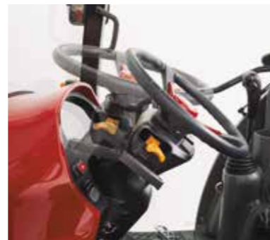
Verstellbares Lenkrad für eine perfekte Anpassung an den Fahrer
