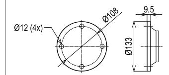
1.DWG.SHOWS MOUNTING BLOCKS AT ORIGINAL HEIGHT. ENGINE WEIGHT WILL COMPRESS BLOCKS BY 4MM(APPROX).
