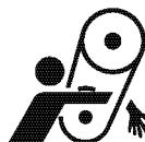
Aldri berør eller la dine klær berøre bevegende deler av motoren under operasjon. Om en del av din kropp eller bekledning blir fanget i
