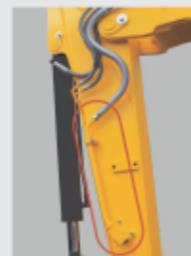
O sistema hidráulico do P.T.O.\* é fornecido como equipamento de série e permite o trabalho com uma grande variedade de acessórios.
