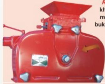
Sistem transmisi *Hulling Head* menggunakan *Full Gear* sehingga penerusan daya lebih optimal dan menghasilkan beras pecah kulit lebih sempurna.
