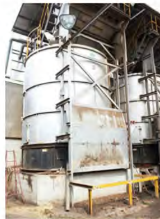
(上)搾乳牛舎とホスピタル牛舎に完備されたフラッシュシステム。一気に流れる大量の水によって床をくまなく洗浄する。(左)糞尿を急速発酵処理するコンポストを3基備えている。1日に15トンの糞尿を処理できる。
