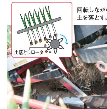
土落としロータの高さ調節はレバーでカンタン。
