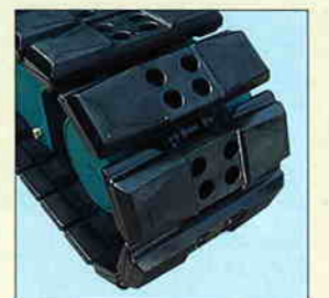
個別に交換できる バットクローラ(オプション)
