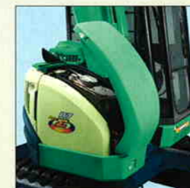
燃料給油口、バッテリーなどを 収納したサイドボンネット
