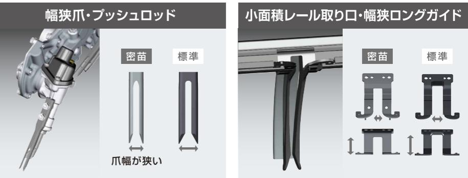
植付け爪やレール取り口の幅が狭く、育苗箱から小面積をより精密にかき取り、浮き苗・欠株の少ない正確な植付けができます。
