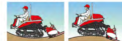
内側のクローラを逆回転させて旋回。
