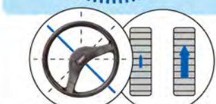
内側のクローラを減速して旋回。
