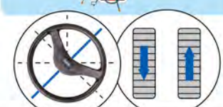
内側のクローラを逆回転させて旋回。
