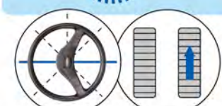
内側のクローラを止めて旋回。
