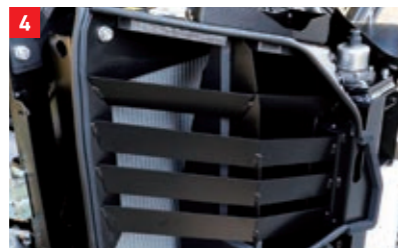
冷却性に優れたラジエーターとオイルクーラを採用。エンジンや作動油の過熱を防ぎ、マシン性能を維持。
