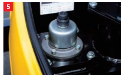
ワンプッシュで圧抜き可能なブリーザ付き作動油タンク。
