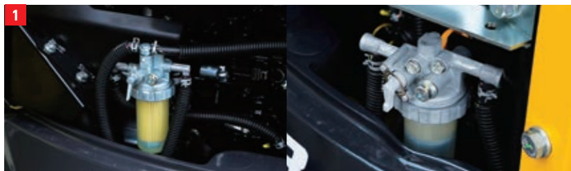
不純物を2重にガードする燃料フィルタとウォーターセパレータ。
