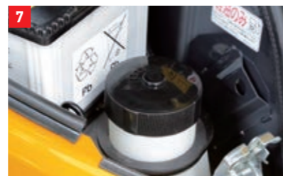
錆びない樹脂製燃料タンク。
