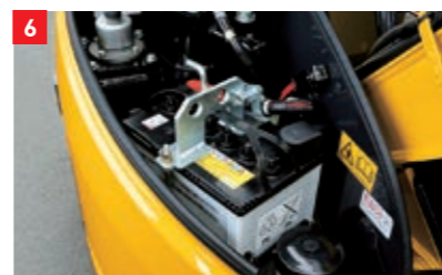
アクセスしやすい右ボンネット内に配置したバッテリー。
