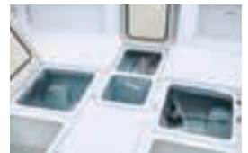
物入れ/プロペラ点検庫/操舵機庫
