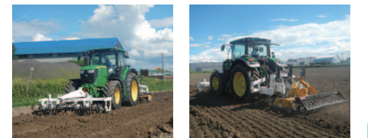
※写真は1台のトラクターで4つの作業機を装着した複合作業。フロントで粗砕土+鎮圧。リヤで心土破碎+パワーハローでの砕土+整地作業。
