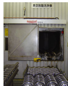
▲ギヤ等浸炭焼入部品の真空脱脂状況
