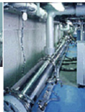
▲ディーゼルエンジン 排気ガス計測装置 (ダイリューショントンネル)
