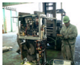
▲冷媒回収(反転による接続口&サービスポート)
