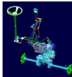
▲ 丸ハンドルコンバインの機構解析
