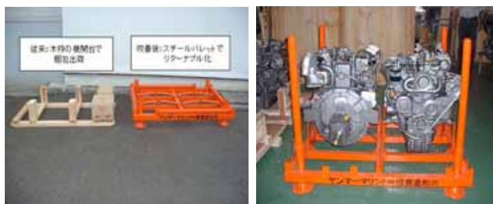
エンジン出荷木台の鉄パレット化(塚口工場)
