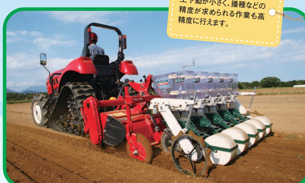
エコトラデルタなら作業機の上下動が小さく、播種などの精度が求められる作業も高精度に行えます。
