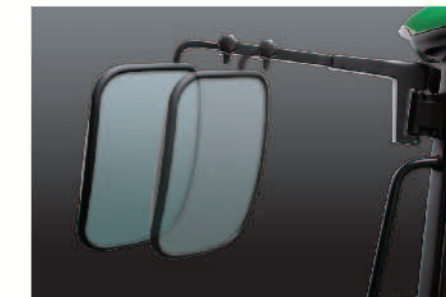
伸縮式大型バックミラー (EQ, EC仕様) 良好な後方視認性を確保、作業状態に合わせて伸縮します。
