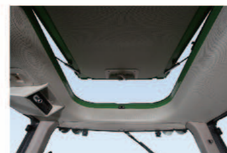
ルーフハッチ (EQ, EC仕様) 新鮮な空気を簡単に取り込める。
