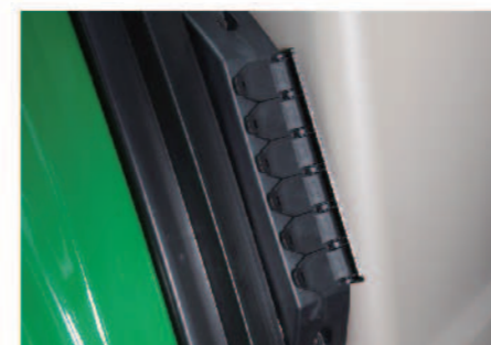
外部電源取り出し
