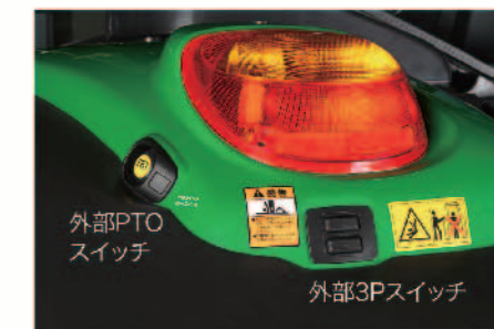
外部リモート3P・PTOスイッチ リアフェンダー部に外部3P・PTOスイッチを装備。 キャブの外で、3P・PTOを操作できます。
