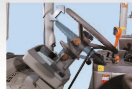
テレスコピックステアリング 最適な運転姿勢が取れるようにハンドル高さの調節が可能。
