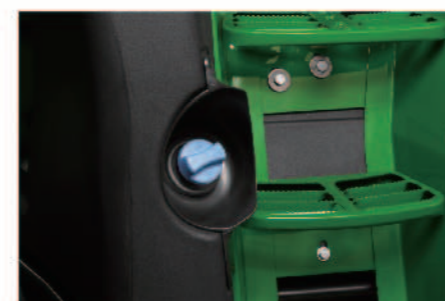
尿素水給水口 SCRシステムにより、NOxを窒素と水蒸気に分解させる為の尿素水の給水口です。
