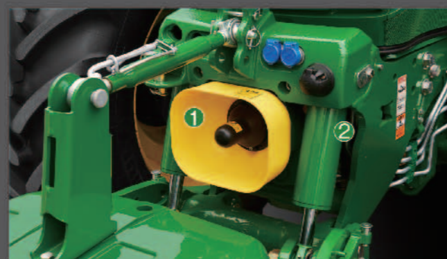
フロントPTO・フロントヒッチ (FP仕様) 複合作業に対応。高能率な作業ができます。 ① フロントPTO ② フロントヒッチ
