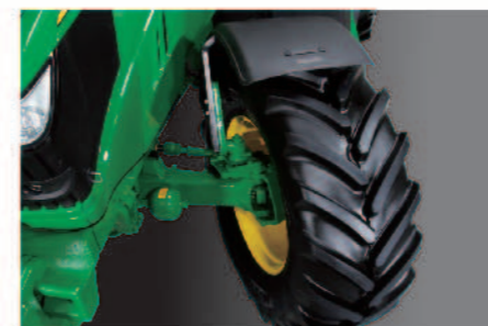
ターンフェンダー より小さい旋回半径を実現。
