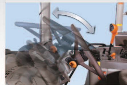
パネル一体型チルトステアリング オペレーターの体格に合わせてハンドルの角度を無段階に調節可能。
