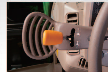
電子式リバーサー 前後進がノークラッチで行える。
