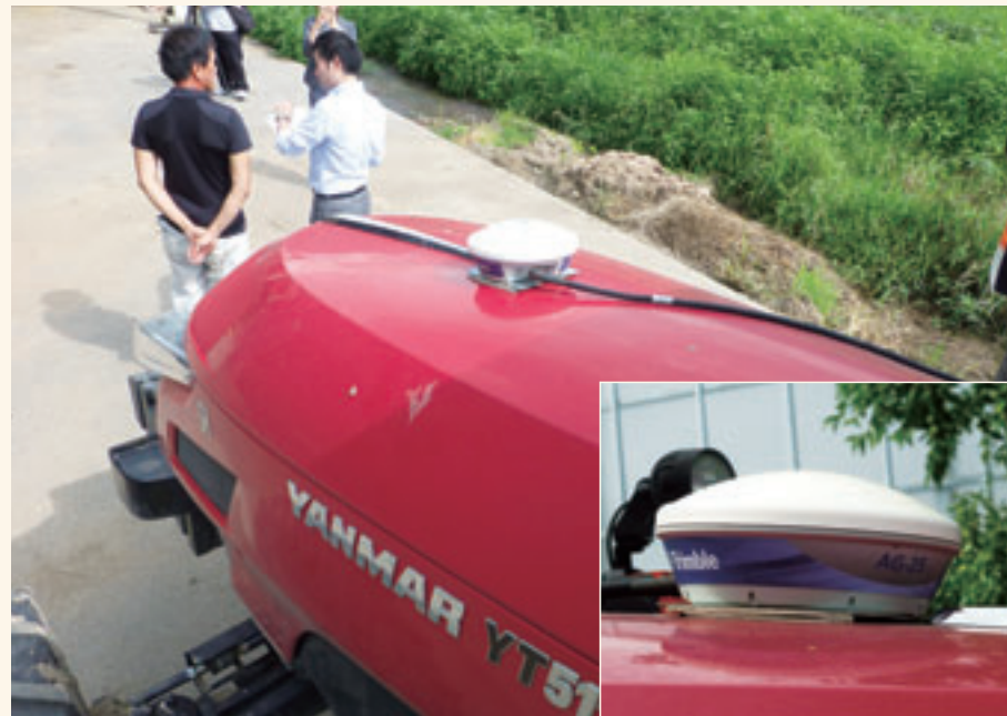
トラクターYT5113のボンネットに装着された、株式会社ニコン・トリンプルのGNSS受信機（AG-25）。画像右下白枠内はアップ画像。
