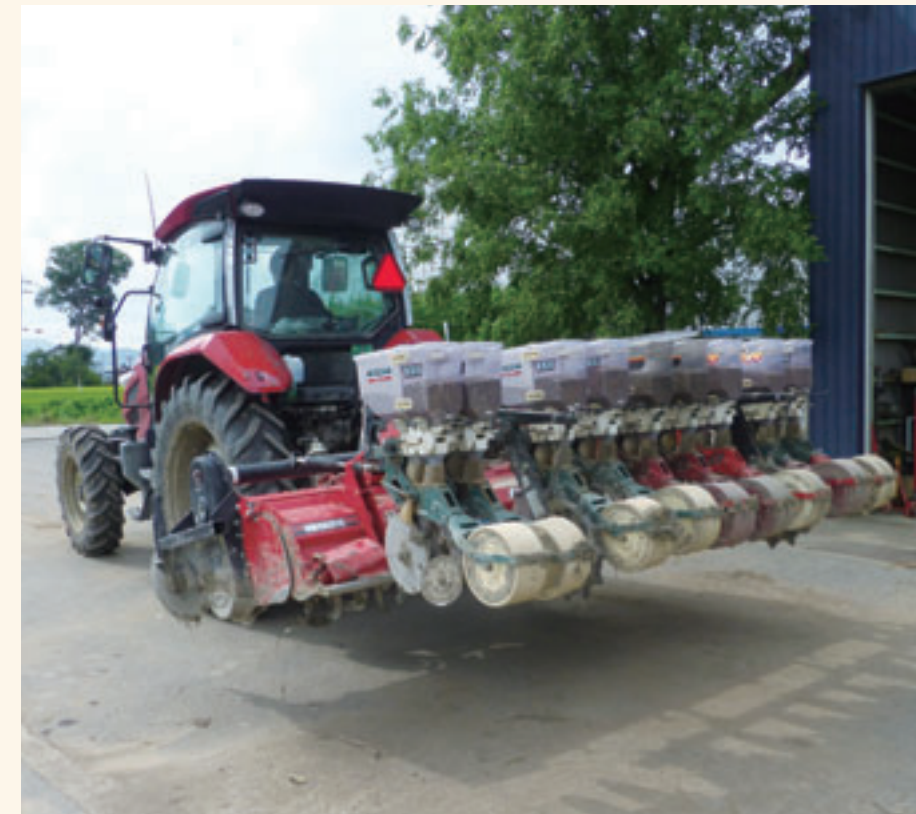
田植えを終えた後、GNSSガイダンス+自動操舵補助システムは、取り外してトラクターYT5113に装着され、大豆の播種に使われるという。
