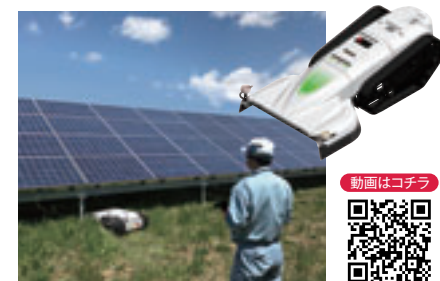
機体寸法 (全長×全幅×全高) 923×655×396mm クローラ外幅 580mm
