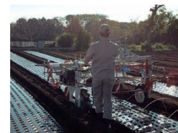
行きは支柱打込み作業
