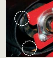
ベルトの上部にベルトガイドが搭載されており、セルフクリーニング機能を備えているため、ベルトの位置調整が不要です。
