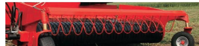
コントローラーでピックアップの速度調整が可能で、ウインドガードと合わせて均一な供給とコンベヤーへのスムーズな送り込みを実現します。また耐久性にも優れた設計を採用しています。
