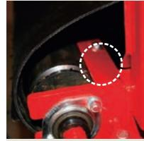
ベルトが最高のパフォーマンスを発揮できるよう、ロールスクレーパーは調整可能で、常にロールをクリーンな状態に保ちます。
