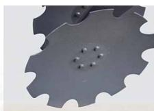
独自の角度で装備された直径510mmの花形カー ブディスクは土にささりやすく、混和能力に優れて います。また、大きめの歯で大量の残渣を一気にすき
