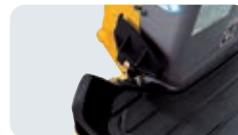
はね上げ格納式ペダル(走行2速/P.T.O.ペダル)(スイングペダル)
