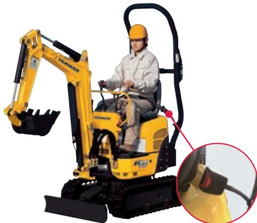
※1 転倒時乗員保護構造/転倒時にシートベルトを装着したオペレーターを保護します。
