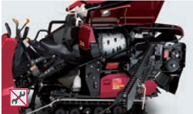
フィードチェンオープン ※1
