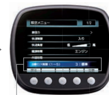
設定メニュー画面 〔カラーセンターディスプレイ〕 ロス低減重視か、作業能率重視か、 5段階で制御レベルを調節できます。
