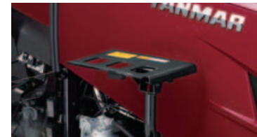
折りたたみ式給油台 重い燃料容器を載せることができ、ラクに給油できます。
