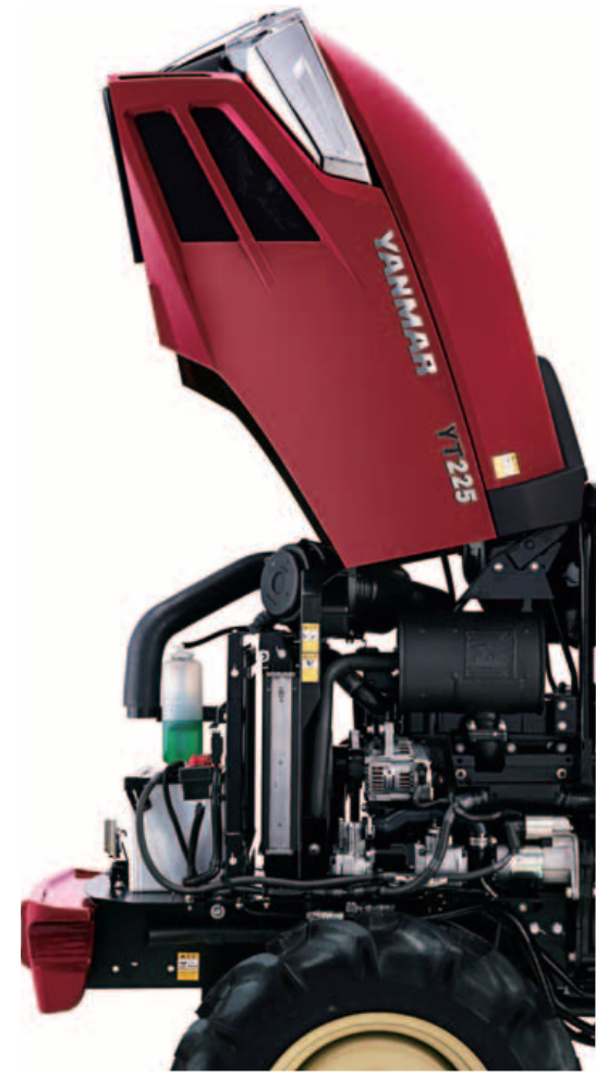
フルオープンボンネット ガスダンパー付きで80度まで開き、点検が簡単に行えます。
