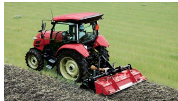
耕うん作業：ロータリー (小橋工業) PTO昇降連動機能により、作業終いもきれいに仕上げます。
