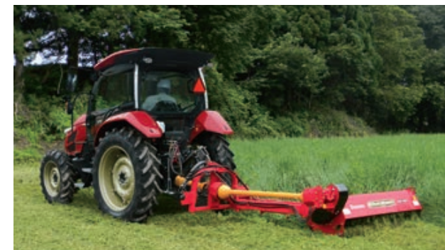
草刈作業：オフセットモア (ササキコーポレーション) 無段変速HMTにより、きれいに仕上げます。
