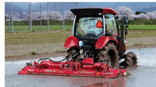
代かき作業：代かきハロー (ササキコーポレーション) 遠心力補正制御により、旋回時も均平を保ちます。
