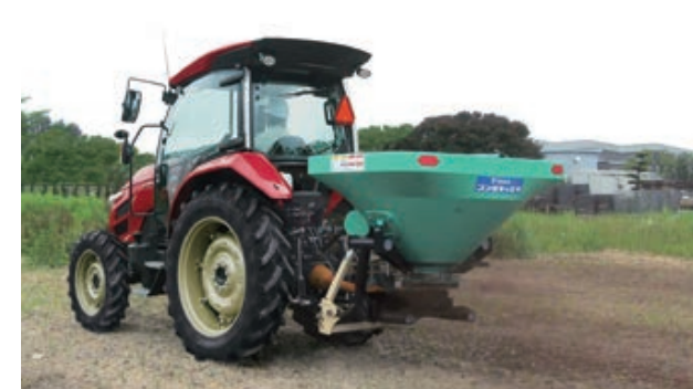
施肥作業：ブロードキャスト (タカキタ) e-CONTROLにより、高効率作業を実現します。
