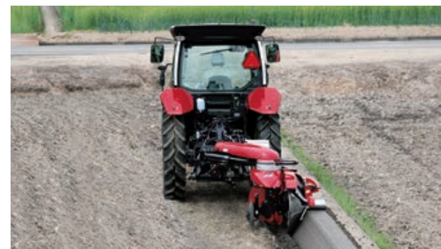
あぜ塗り作業：あぜ塗り機 (小橋工業) 無段変速HMTにより、きれいに仕上げます。
