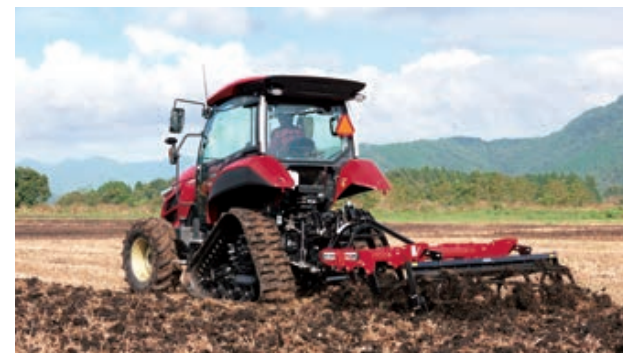
粗耕起作業：スピードカルチ (松山) A/Bモード切換により、旋回時は自動減速でき安心です。
