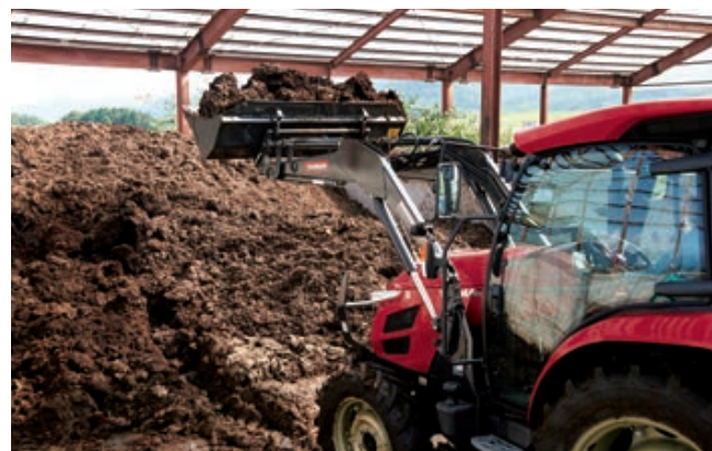
フロントローダー (三陽機器) レバーを持ち換えることなく、ローダー操作レバーひとつで車速調整とローダー操作が簡単にこなせます。
