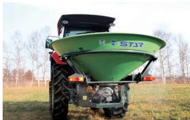
ブロードキャスト (IHI スター) ほ場条件により、車速を変化させても散布量は一定です。
