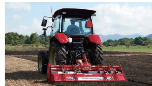
耕うん作業：ロータリー (松山) PTO昇降連動機能により、作業終いもきれいに仕上げます。
