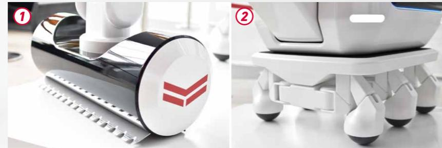
①Sub機は床剥がしのアタッチメントを装着し簡単に作業可能。また、廃材の自動仕分け機能を搭載。
