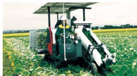
キャベツの刈取り、選別調製、大型コンテナへの収納まで、一貫して機上で作業を済ませることが可能に。労働時間を40%削減するとともに、段ボールをはじめ資材費をカットするなど、出荷経費を30%削減します。農作業の軽労化を図ると同時に、新たな大規模産地の実現が期待できます。
