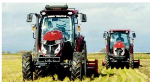
タブレット端末でかんたんに操作できる、無人トラクター。有人トラクターと並走し、農作業を「誰でも」「正確に」「効率良く」行える、人とロボットによる協調作業を実現します。将来は完全自動化も視野に。誰でも作業でき、新規就農をしやすく。労働力不足という課題にも応えます。
