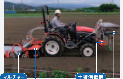
マルチャー ロータリー + うね立て整形機 土壌消毒機 施肥機
