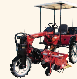
ミッドマウント管理作業車+ 3連中耕ロータリー (幅狭カバー付)+培土器 MD20+RM301MD,CRTH (+RM301MD-HK,CRTHA)+ イエロー培土器MD (7S0076-12000)×3個
