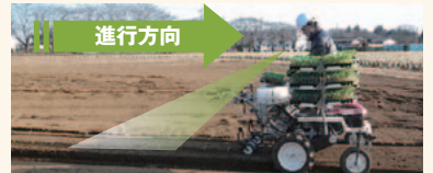
乗用汎用野菜移植機 PH2R(1畦2条千鳥植え) PH2R,W(1畦2条千鳥植え・1畦1条(同時2条))
