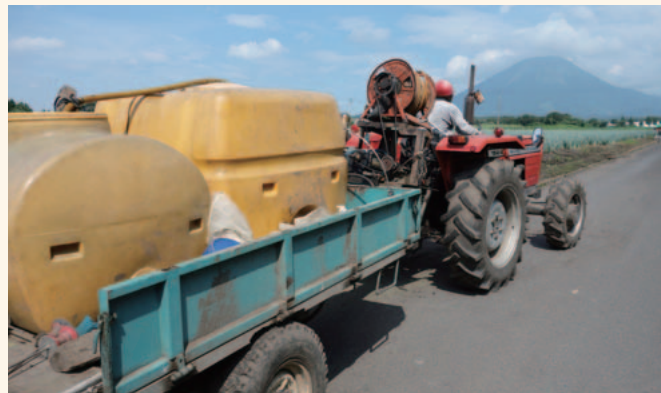
以前から使っていた防除システムは、独自につくられたPTO駆動式のホースリールと、運搬車に積んだ1500Lのタンク。なかなかの重装備だ。
