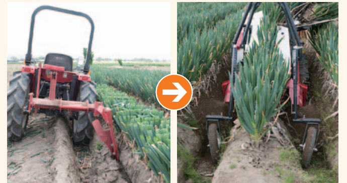
トラクター用掘取機でうねを切る慣行収穫作業(左)と、左右のロータでうねを崩しつつ、搬送ベルトで引き抜くHL1。
