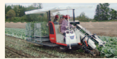
キャベツ収穫機 HC125(25PS・中型) HC141(41PS・大型)
