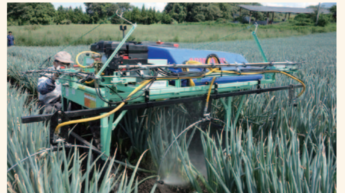
オリジナルの逆U字形の散布機構。ネギの根元に薬剤を散布できる。
