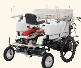
乗用汎用たまねぎ移植機 PH4R,T1S・ PH4R,T1A(1人乗り) ※写真はPH4R,T1A
