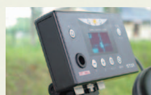
GPSナビライナー シンプルでわかりやすい、トラクター用の経路誘導システム。
