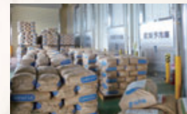
2013年に完成したたまねぎ乾燥施設は、床面積1,360㎡、616室のラックで個別の乾燥・管理が可能。4,000tの収量にも対応できる(写真上)。乾燥室内で24~36時間かけて水分を5%下げる(写真左)。
