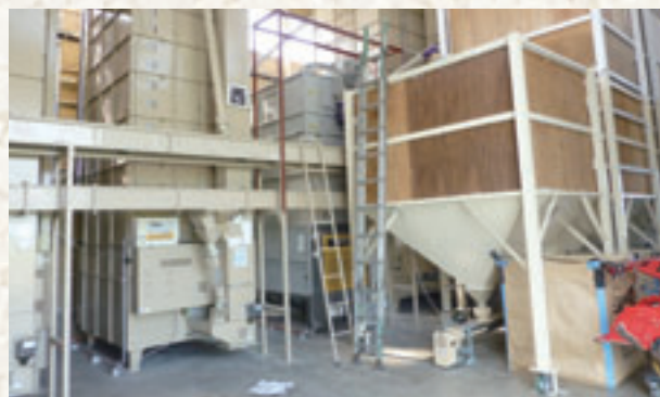
ミニライスセンターの核とも言える乾燥機(写真左)と貯蔵タンク(写真右)。搬送コンベアも上にかけて清掃をしやすくしている。
