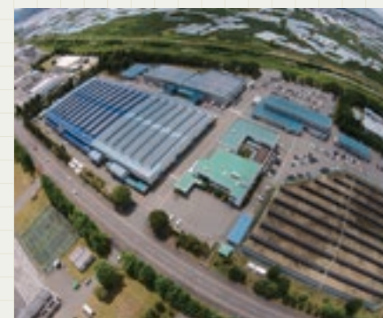
旧グラウンド（写真右下）と工場・流通倉庫（写真左上）の屋根には、約1.9MWの電力を発電する、太陽光発電設備が設置されている。
