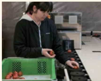
ひかり庵の導入で、果実全体の内部情報が計測でき、選果作業も大幅に効率化した。
