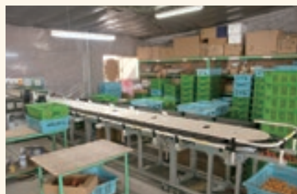
収穫したトマトを手前のレーンに置くと、左奥のセンサを通過する際に糖度・酸度などを検出。奥のレーンでは流れてきたトマトを糖度の高いものから落としていく。
