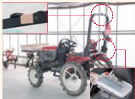
アンテナ(写真左上)と本体(写真右下)を組み合わせた、手づくりのGPSシステム。先日このシステムで、肥料をまいたという。
