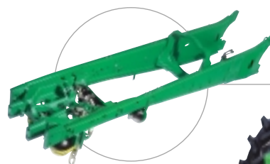
タフな作業力とキャビンの快適性を 実現したフルフレーム構造
