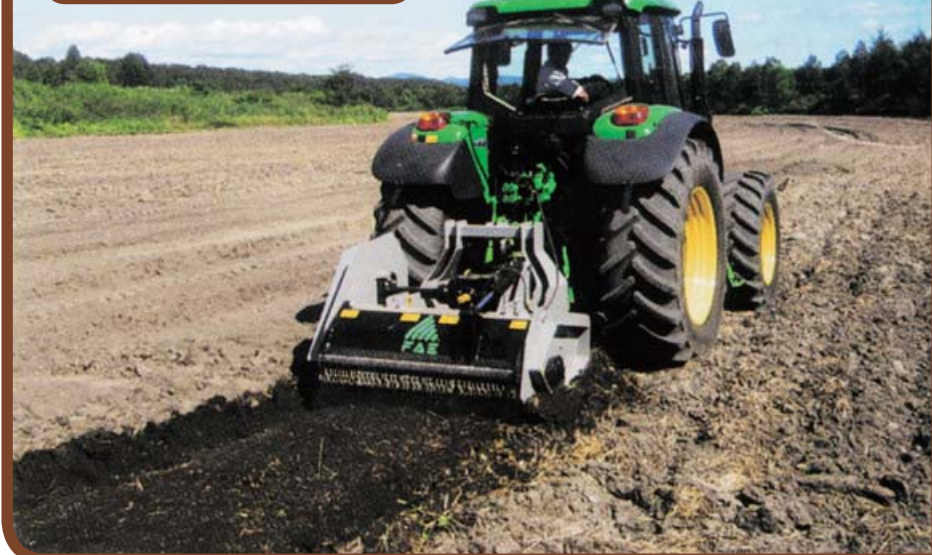
試験に使われたSTC125（作業幅1.25m。適応トラクターは90～110ps）。現地での導入事例も多い。
